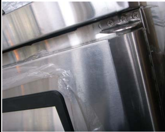
A. Unscrew the top hinge
